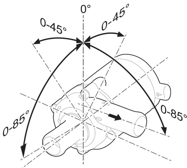
Рис. 802 Установочные положения циркуляционного насоса U4847 Esop
