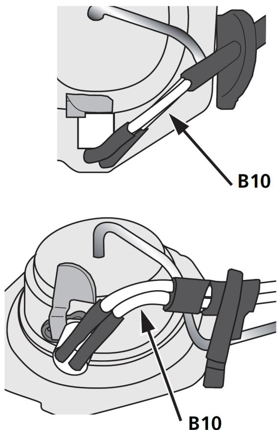
Рис. 915 Расположение кабеля штифта накала с небольшим изгибом
