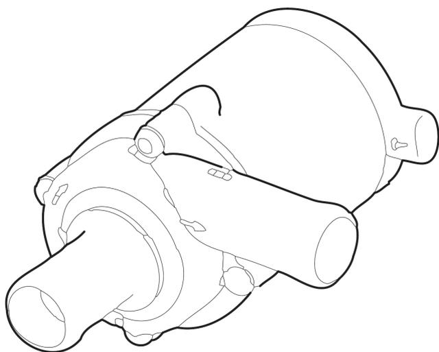
Рис. 205 Циркуляционный насос U4847 Ecom
