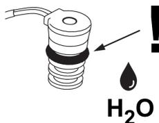
Рис. 918 Смачивание уплотнений
