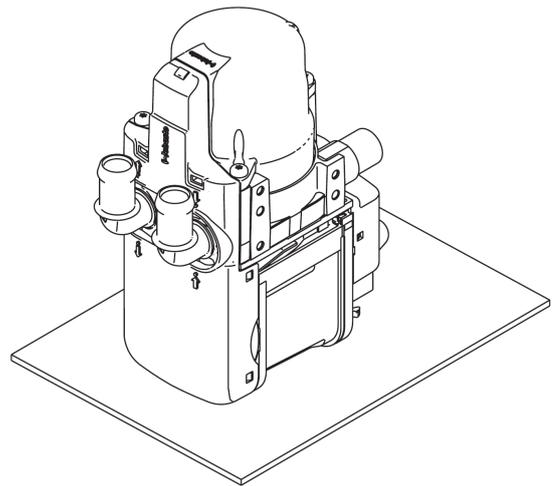
*Рис. 1001 Рекомендуемые положения для складирования и транспортировки подогревателей Thermo Top Evo*
