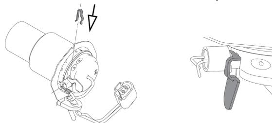
Рис. 912 Установите удерживающую пружину
