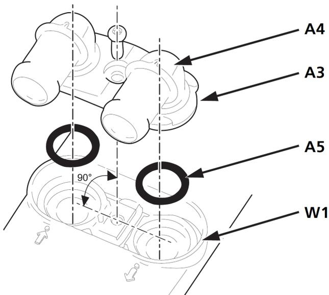
Рис. 924 Установка пластины крепёжной жидкостных патрубков
