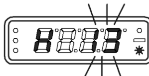
Рис.6.20- Индикатор при отказе подогревателя
