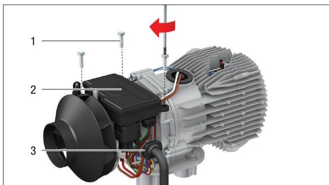
1 Крепежные винты M4 x 16 (Torx)      2 Блок управления
