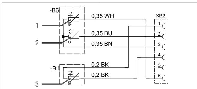
1 Датчик перегрева NTC 50 кОм    3 Датчик на впуске воздуха
