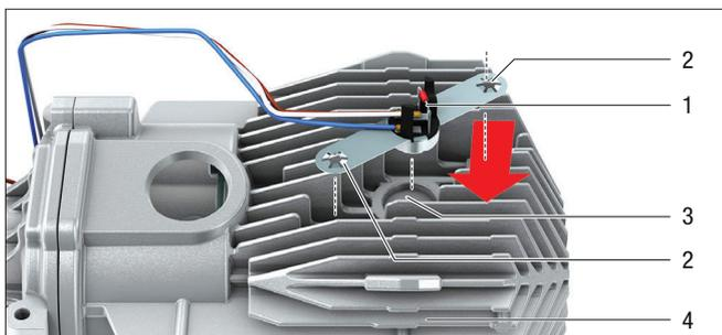
1 Комбинированный датчик 3 Установочное углубление
