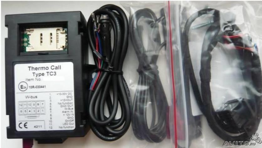
Модуль позволяет запускать отопитель звонком или SMS-сообщением. В нем присутствует функция подтверждения запуска по SMS. Так же есть возможно задать время запуска отопителя на ближайшие 24 часа (функция таймера). Имеет встроенный датчик температуры. Совместим со всеми отопителями компании Webasto, в том числе с Thermo Top Evo 5 и 4. В комплекте поставки есть кнопка принудительного запуска отопителя из салона.
