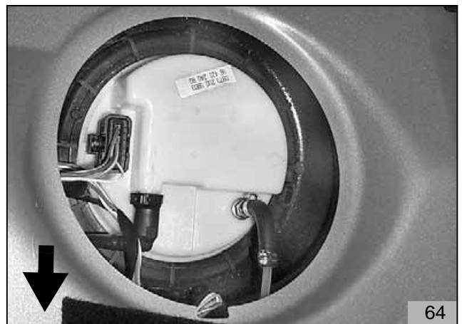
**Brennstoffentnahme bei Tankarmatur mit zwei Anschlüssen (Version 1)**
