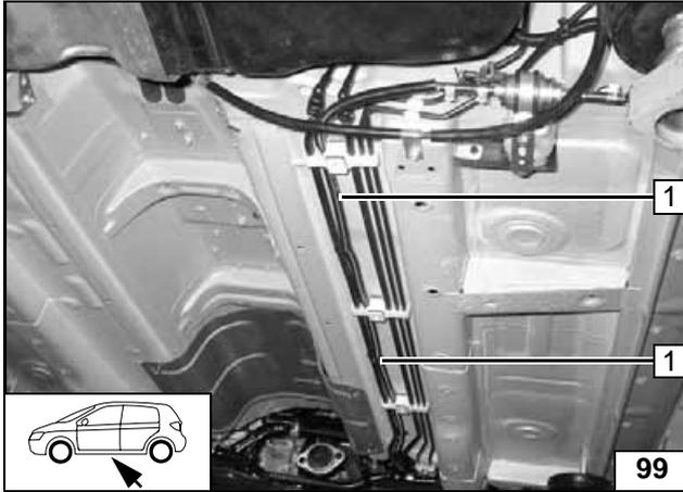
Brennstoffleitung und Kabelbaum Dosierpumpe **1** entlang fahrzeugeigener Leitungen im Wellrohr zum Einbauort Dosierpumpe verlegen und mit Kabelbinder befestigen.
