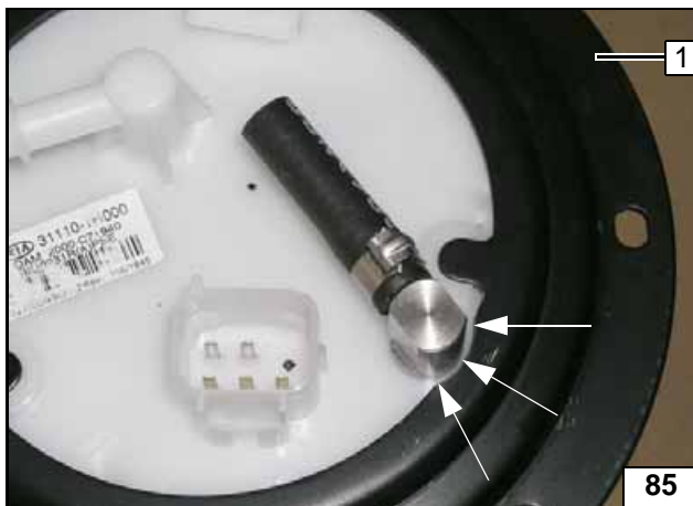
Befestigungsflansch 1 im Bereich an der Mar- kierung aussparen
