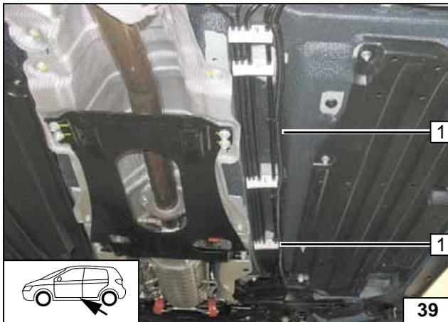
Brennstoffleitung vom Heizgerät in Wellrohr am Längsträger zur Spritzwand verlegen. Brennstoffleitung vom Heizgerät und Kabelbaum Dosierpumpe in Wellrohr 1 an fzg.eigenen Kraftstoffleitungen zum Unterboden und weiter zum Einbauort Dosierpumpe verlegen!
