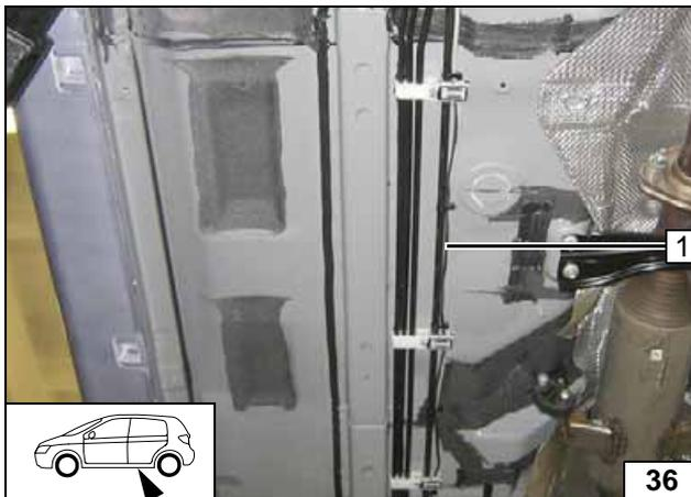
Brennstoffleitung und Kabelbaum Dosierpumpe 1 entlang der fahrzeugeigenen Leitungen verlegen und mit Kabelbindern sichern!
