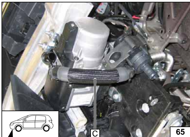
Schlauch C mit 90°- Bogen am Heizgeräteeingang montieren.
