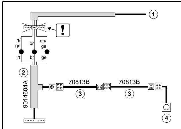
! 6- poligen Stecker vom Kabelbaum Telestart abtrennen und entsorgen - bei bereits montiertem Telestart vorher vom Empfänger abziehen. Dabei Leitungen rt/gn, br und gn/ge einzeln durchtrennen (Plus- und Masseleitung) und mit den Leitungen rt, br und ge vom Y-Adapter verbinden (Stoßverbinder crimpen und schrumpfen)!
