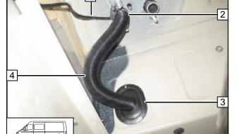
Beim Einsetzen der Gummitülle **3** auf freie Brennlufteintrittsöffnung achten! Kabelbaum Dosierpumpe **1** durch den Schlitz am Stutzen Brennluft herrausführen.
