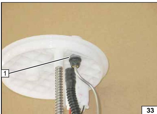
An Position **1** vier Unterlegscheiben  $\varnothing d_a = 11,6\text{mm}$  als Höhenausgleich einfügen!
