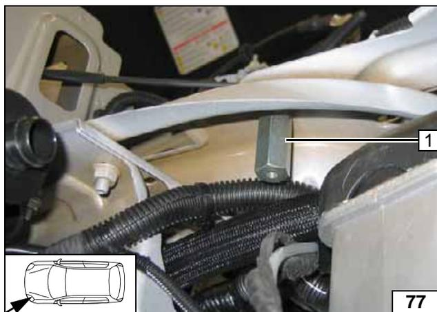
Distanzmutter M6x40 **1** an fzg.eigene Schraube montieren!
