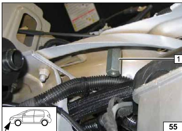
Distanzmutter M6x40 1 an fzg.eigene Schraube montieren!
