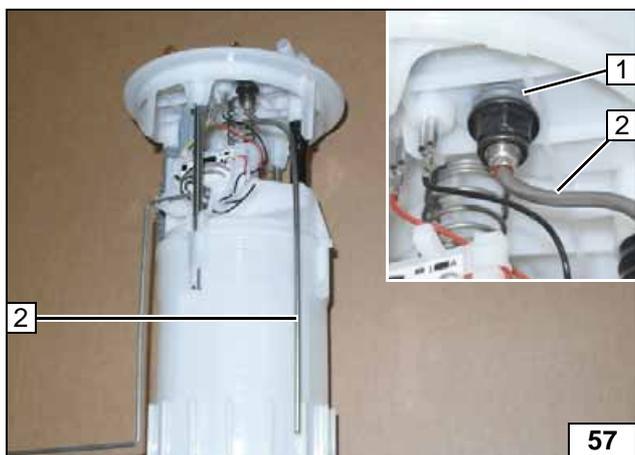
Drei Unterlegscheiben  $\varnothing d_a = 12$  an Position 1 als Höhenausgleich einfügen!
