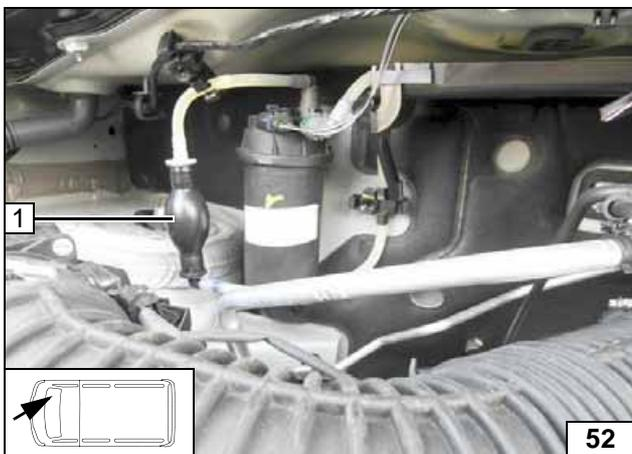
Die Brennstoffentnahme ist ausstattungsabhängig. Bei Fahrzeugen mit Handpumpe 1 (ohne Vorförderpumpe im Tank) erfolgt die Brennstoffentnahme mit T-Stück in der Vorlaufleitung! - Variante 1!
