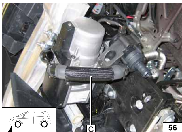
Schlauch C mit 90°- Bogen am Heizgeräteeingang montieren.
