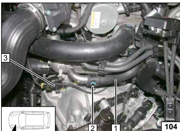
Halterung vom Stecker 3 um ca. 180° nach vorn drehen!
