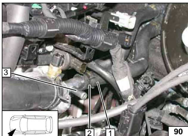
1 Schlauch Motorausgang / Wärmetauschereingang abziehen 2 Fzg.eigene Federbandschelle wird wieder verwendet
