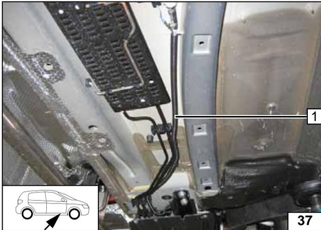
1 Brennstoffleitung, Kabelbaum Dosierpumpe in Wellrohr
