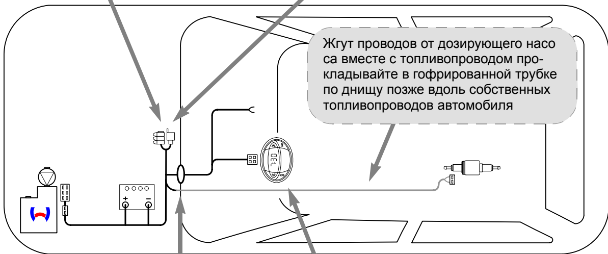
Схема прокладки жгута проводов
