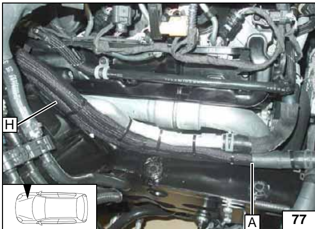
Schlauch A und H ausrichten und mit Kabelbinder befestigen!
