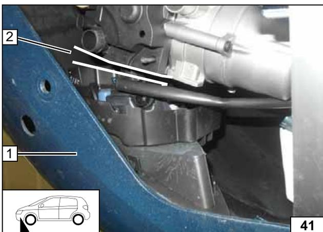
Stoßfänger 1 probeweise montieren und Abstand (mind. 15mm) vom Heizgerät zum Nebelscheinwerfer im Bereich 2 prüfen, ggfs. korrigieren!
