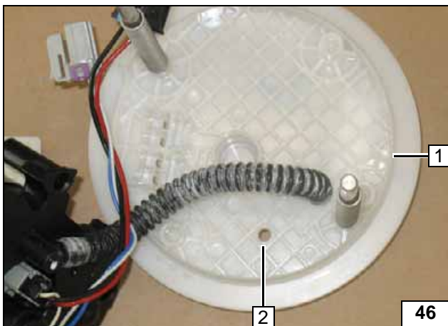
Tank gemäß Herstellerangaben ausbauen. Tankarmatur 1 gemäß Herstellerangaben ausbauen und demontieren!
