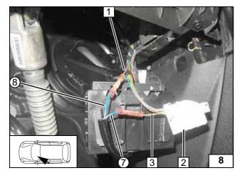
Anschluss am 26-poligen Stecker Klimasteuergerät **2** A195\*2B!
