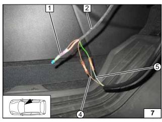
Leitung rt 4² und Leitung rt/sw 0,5² vom Kabelbaum Heizgerät **2** mit Lötverbinder **1** verbinden!
