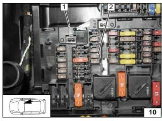
Anschluss +15 erfolgt hinter Sicherung F53 AUC-Sensor 2 an Sicherungs- und Relaisbox 1!
