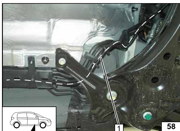
Brennstoffleitung und Kabelbaum Dosierpumpe in Wellrohr Ø 10 1 an fzg.eigenen Kraftstoffleitungen zum Unterboden verlegen und mit Kabelbinder sichern!
