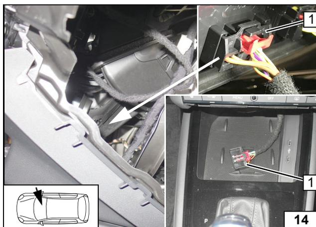
20-poligen Stecker A **1** vom Klimabedienteil lokalisieren, lösen und zur Mittelkonsole verlegen!
