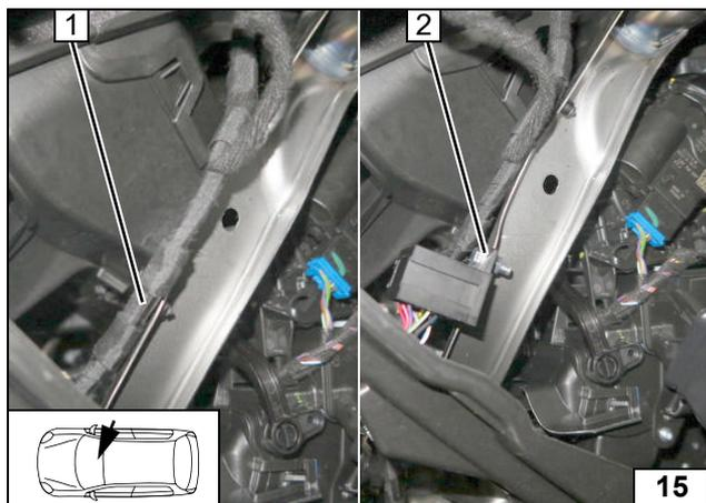
Fzg.eigenen Kabelbaum aus Halteöse 1 lösen und nach hinten neu verlegen.
