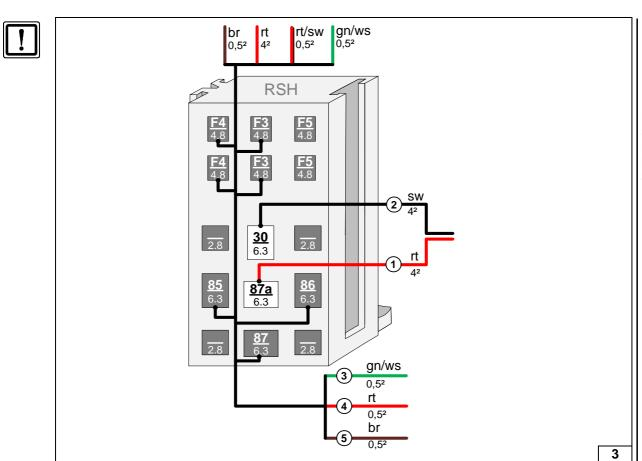
Leitungen in Relaissicherungshalter Innenraum anschließen
