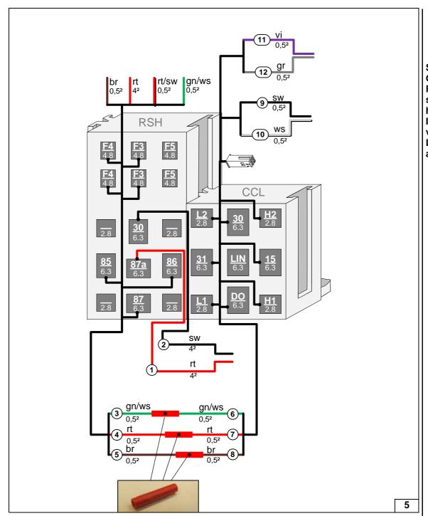
Sockel CCL-GW und Relaissicherungshalter Innenraum verrasten, Leitungen anschließen
