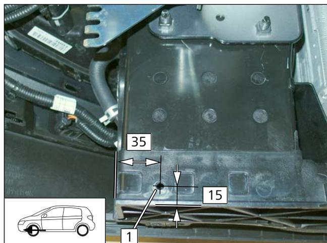
1 Bohrung Ø7
