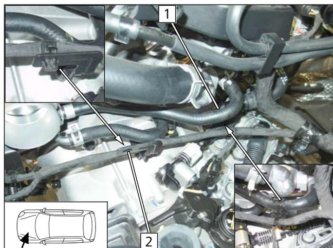
► Schlauchhalter an Position **1** und Kabelhalter an Position **2** entsorgen.
