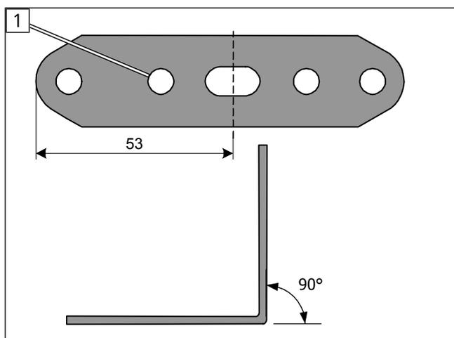
**1** Anschraubpunkt Abgasschalldämpfer
