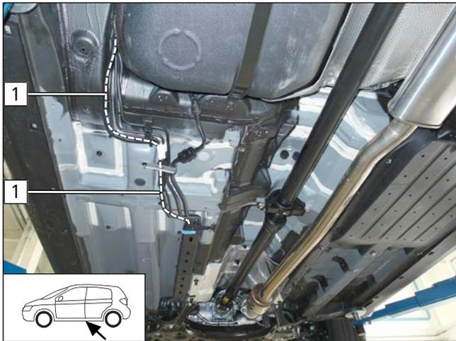
► Kraftstoffleitung und Kabelbaum Kraftstoffpumpe in Wellrohr Ø10 **1** entlang der fzg.eigenen Kraftstoffleitungen zum Einbauort Kraftstoffpumpe verlegen und mit Kabelbinder sichern.
