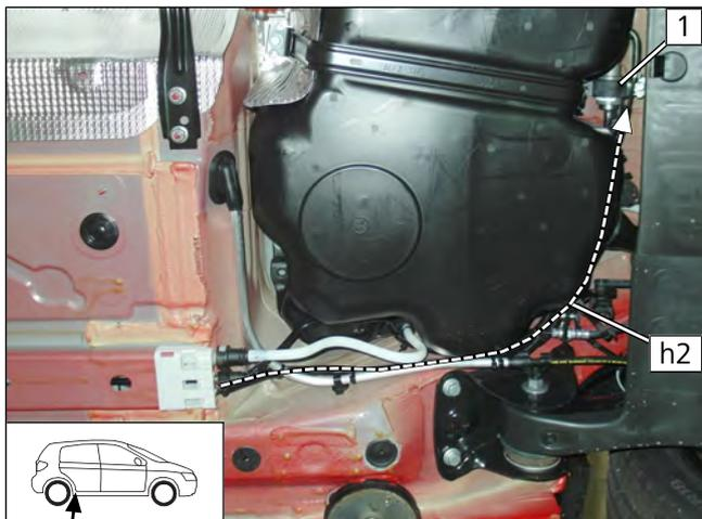
► Kraftstoffleitung und Kabelbaum Kraftstoffpumpe in Wellrohr **h2** einziehen und gemäß Abb. zur Kraftstoffpumpe **1** verlegen.
