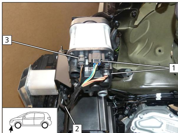
► Kabelbäume **2** am fzg.eigenen Kabelbaum entlang verlegen und befestigen.
