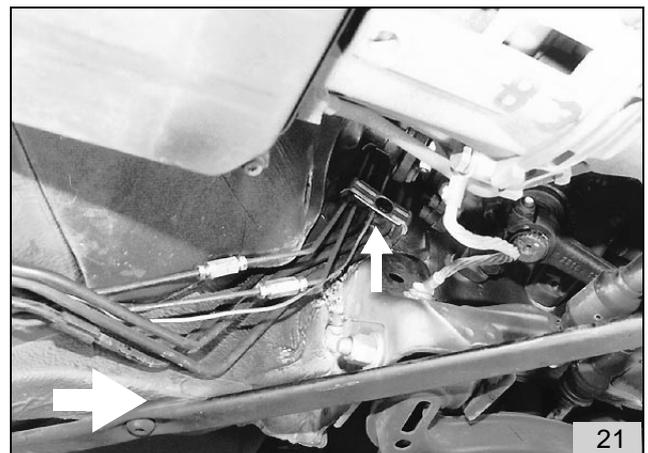
Brennstoffleitung an den Kraftstoffleitungen am Unterboden links nach hinten führen (Bild 22)
