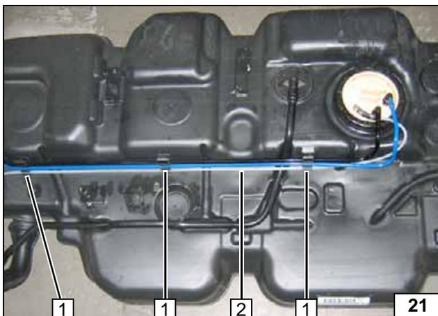
Brennstoffleitung vom Tankentnehmer 2 in vorhandene Befestigungspunkte 1 [3x] einsetzen. Tank wieder montieren!
