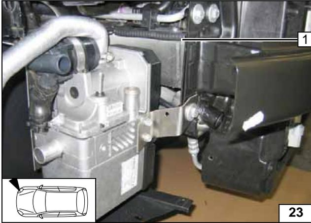
Kantenschutzprofil 1 100mm gemäß Bild einsetzen!
