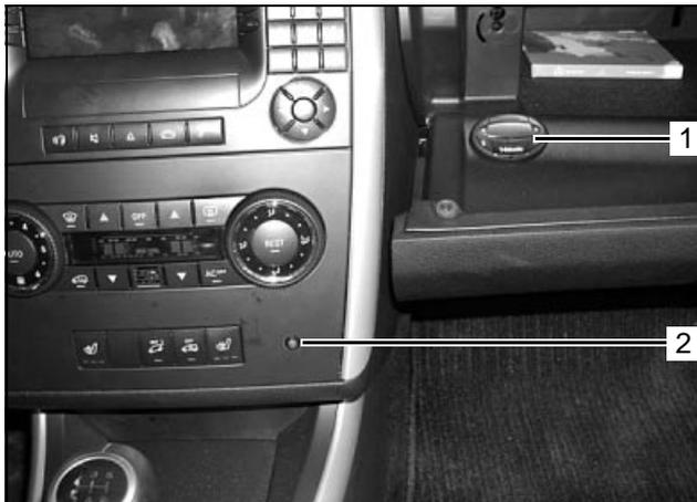
Bei der Montage der Vorwahluhr im Handschuhfach, oder wenn als Bedienteil nur Telestart und / oder Thermocall verwendet wird, ist unbedingt eine optionale Betriebsanzeige im Sichtbereich des Fahrers zu installieren
