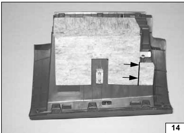
**Dämmung** vom Handschuhfach an der Markierung wegschneiden!.
