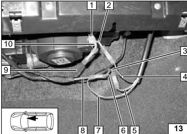
Anschluß am 2-poligen Stecker 1 vom Gebläsemotor.
