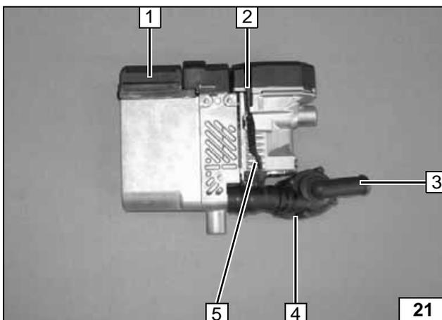
Adapterleitung Wasserpumpe 2 aufstecken, ablängen und mit Kabelbaum Wasserpumpe 5 mittels Stoßverbinder farbgleich verbinden (crimpen und schrumpfen).
