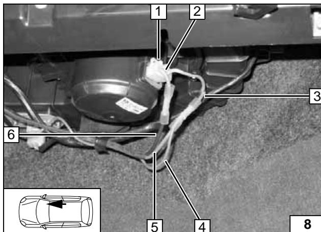
Anschluß am 2-poligen Stecker 1 vom Gebläsemotor.
