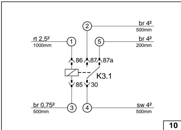
Verbindungen gemäß Schaltplan herstellen. Leitungen ①, ② und ④ in beiliegenden Isolierschlauch einziehen!
