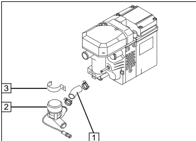
Wasserpumpe 2 vom Heizgerät demontieren. Schlauchstück 1 und Federbandschellen werden wieder verwendet. Halteschelle 3 und Schraube entsorgen!
