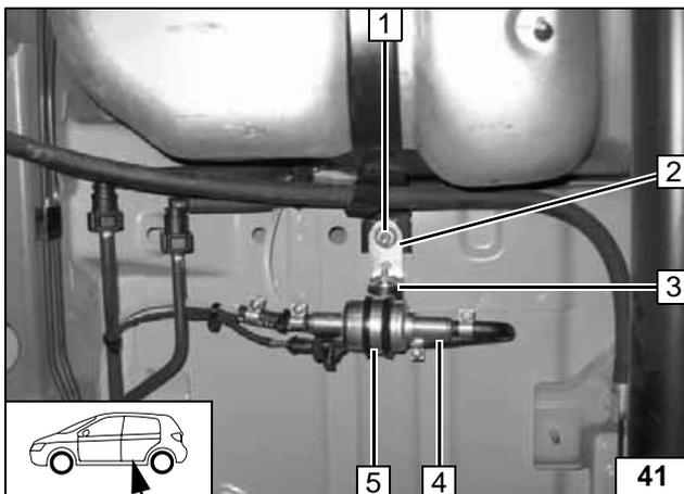
Einbaulage Dosierpumpe beachten, siehe „Einbauanweisung“!
