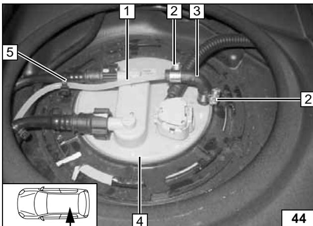
Verschluss vom vorhandenen Entnahmestutzen abschneiden und 90°-Formschlauch 3 mit kurzem Ende aufstecken!
