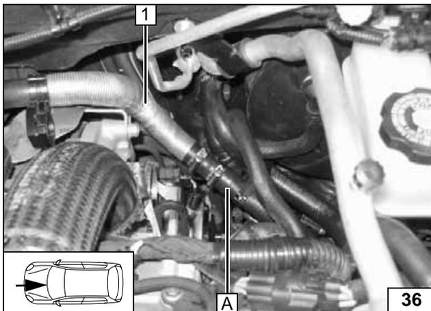
Wasserschläuche vor dem Verbinden mit Kühlmittel befüllen!
