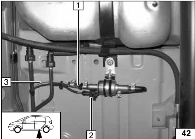
Brennstoffleitung vom Heizgerät an Druckseite der Dosierpumpe [Seite mit Stecker].
