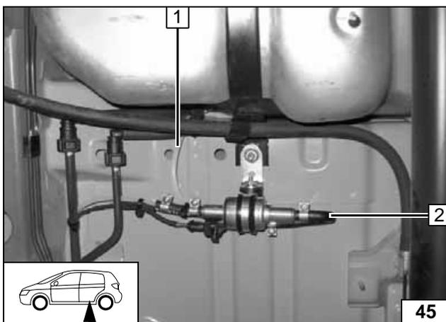
Brennstoffleitung 1 vom Brennstoffentnehmer an Saugseite der Dosierpumpe [Seite ohne Stecker].
