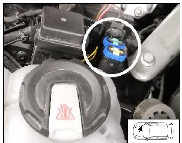
Расположение колодки с предохранителями
