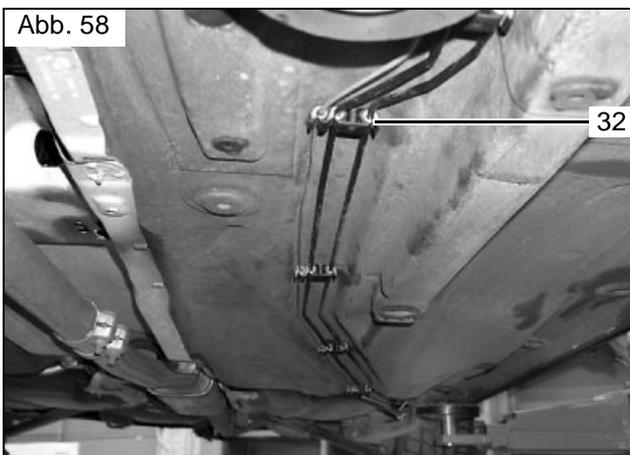
**Montage - Metall-Brennstoffleitung (Abb. 58)**
