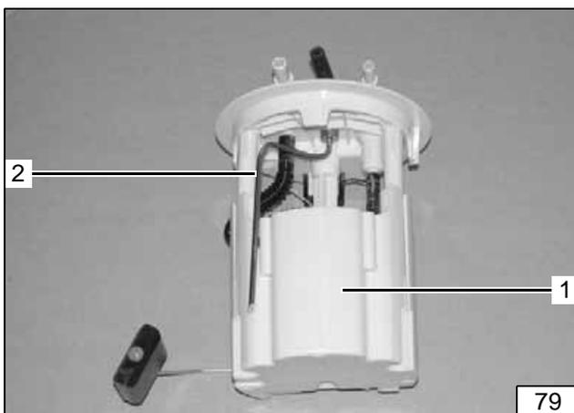
Tankentnehmer gemäß Schablone formen, ablängen und einsetzen, siehe „Einbauanweisung“!
