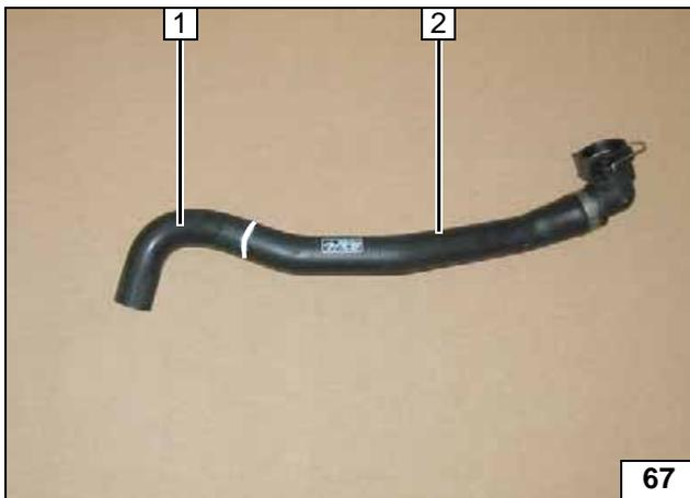
Schlauchstück an der Markierung trennen. Schlauchstück 1 wird wieder verwendet. Schlauchstück Motorausgang 2 am Stutzen Motorausgang wieder montieren!
