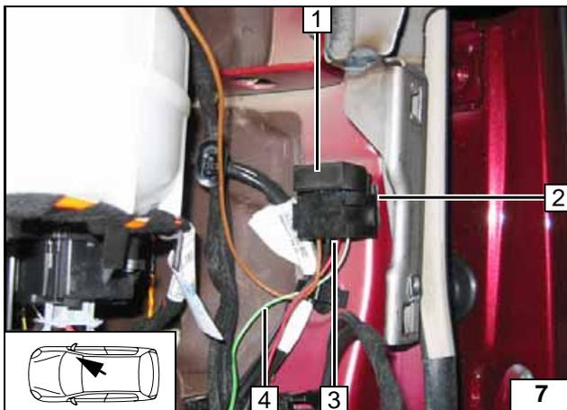
Vor Montage Leitung gn/ws 4 von K3/86 an Sockel IPCU Klemme 86 anschließen!
