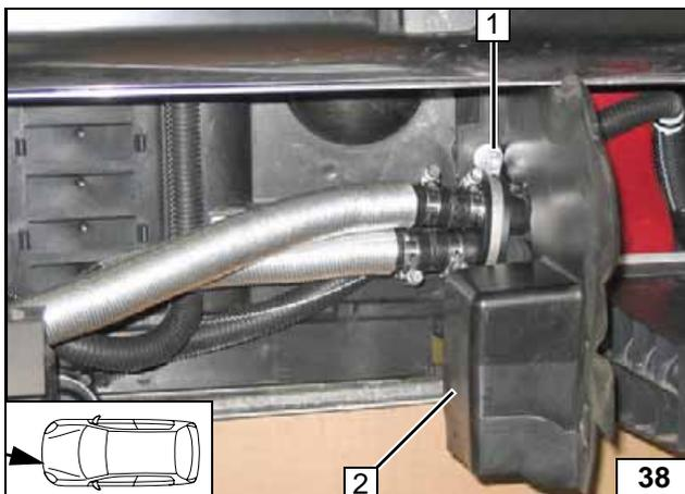
Schlauch **B** und **E** mit gummierter Rohrschelle zusammen mit Trennwand **2** befestigen!
