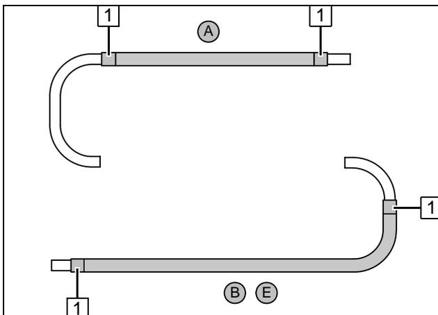
Flechtschutzschläuche auf Schlauch A - B und E aufschieben und ablängen. Schrumpfschlauch zuschneiden und auf-schrumpfen!
