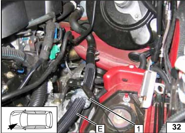
Vor der Montage Profilgummi sw 1 auf Schlauch E aufschieben!
