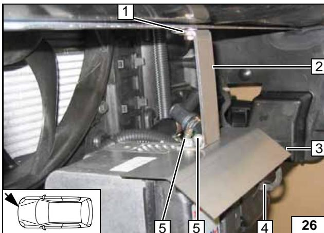
Vor der Montage des Windleitbleches 3 Kabelbaum Heizgerät 4 aufstecken!
