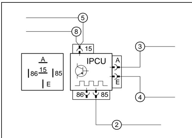
Leitungen an IPCU (IPCU-Ansicht kontaktseitig) anschließen. Leitung 5 in den beiliegenden Isolierschlauch einziehen und zur OBD-Steckdose verlegen. Leitung 8 nur bei Klimaautomatik
