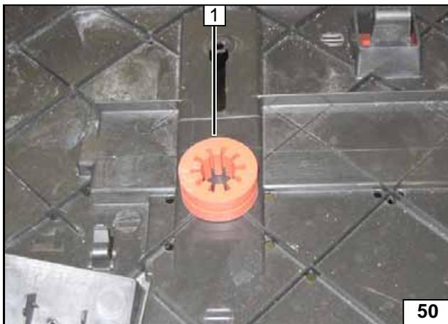
Profilgummi rt an Position 1 auflegen, Lochbild übertragen und Bohrung Ø 42mm in Unterfahrschutz!
