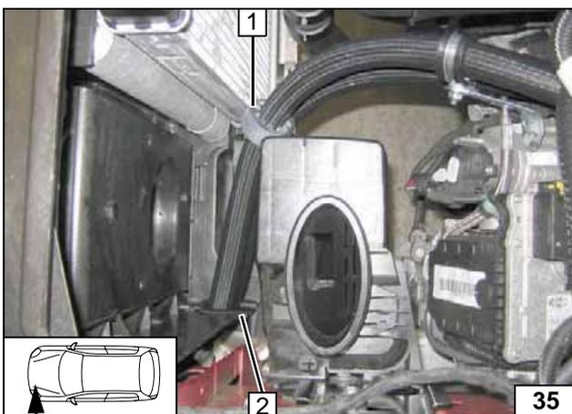
Vor der Montage Profilgummi sw 1 [2x] auf Schlauch B und E aufschieben!
