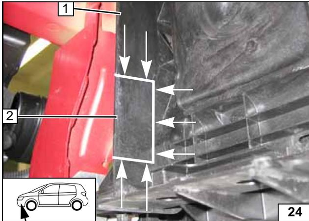
Seitenteil Kühlerträger 1 an den Markierungen wegschneiden!
