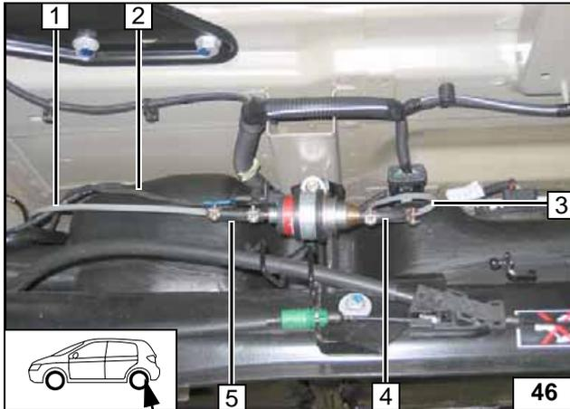
Brennstoffleitung vom Heizgerät **1** an Druckseite und Brennstoffleitung vom Tankentnehmer **3** an Saugseite der Dosierpumpe anschließen.
