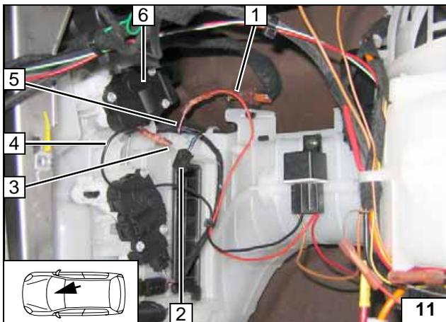
Die Umsteuerung der Luftverteilung erfolgt am 4-poligen Stecker 4V NR 2 vom Klappenmotor 6.
