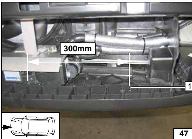
Bohrung 1 Ø 6,2mm gemäß Abbildung mittig des Rasters bohren.
