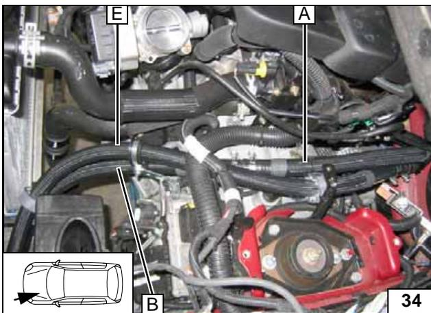
Schlauch B und E durch gummierte Rohrschellen verlegen.
