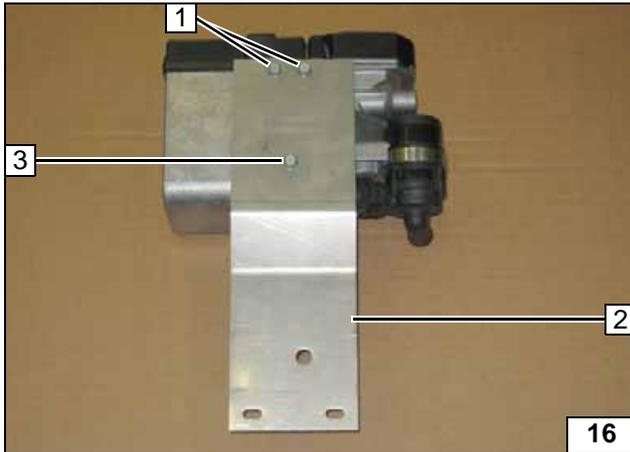
An Position 3 zwischen Halter 2 und Heizgerät zwei Scheiben einfügen.
