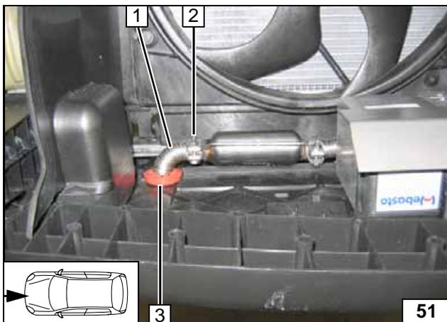
Profilgummi 3 in Bohrung Ø 42mm einsetzen! Lage der Bauteile kontrollieren, wenn nötig korrigieren. Auf Freigängigkeit achten!
