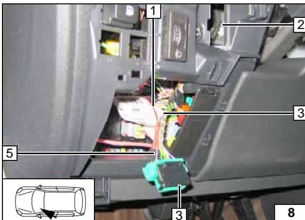
Die Umsteuerung der IPCU erfolgt an der 16-poligen OBD-Steckdose 3.
