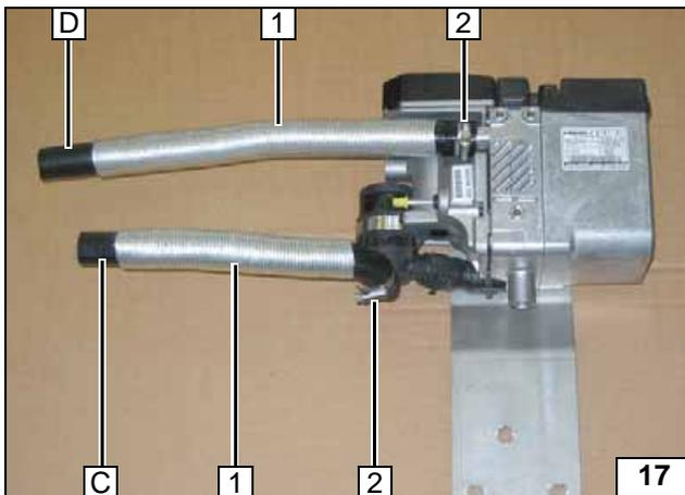
Wärmeschutzschlauch 1 [2x] auf Schlauch C und D aufschieben und ablängen.
