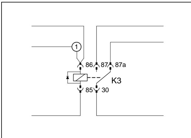
Verbindungen gemäß Schaltplan herstellen. Leitungsabschnitt 1 in den beiliegenden Isolierschlauch einziehen und zusammen mit Kabelbaum Vorwahluhr und Gebläseansteuerung in den Innenraum verlegen.
