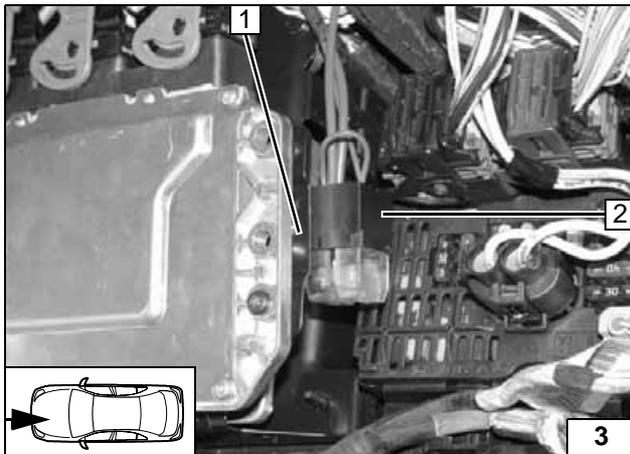
Bohrung  $\varnothing$  4mm in Halterung vom Motorsteuergerät an Position 1. Halteplatte Sicherungshalter mit Schraube M4x12 und Mutter M4 an Halterung vom Motorsteuergerät befestigen.
