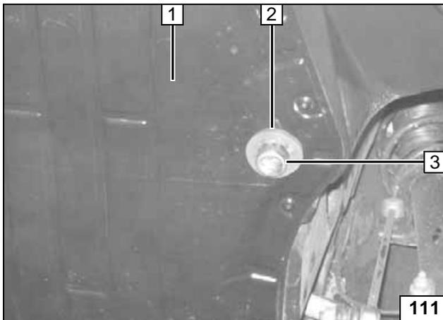
Zuerst Profilgummi rot 2 von unten auf Abgasendstück 3 positionieren, dann mit Nut in den Unterfahrschutz 1 einsetzen! Endkappe vom Abgasendstück 3 bündig am Profilgummi rot 2 gem. Bild ausrichten!
