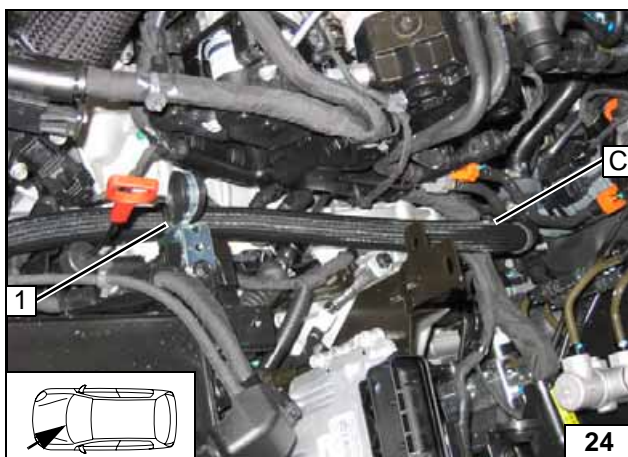
Schlauch C durch untere gummierte Rohr- schelle 1 verlegen!
