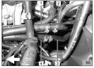
Wasserschlauch 1020mm lang (51/1) und Wasserschlauch 890mm lang (51/2) gemäß Bild 51 ausrichten und mit Kabelbinder befestigen
