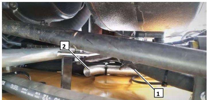
Укоротить выхлопную трубу до 400мм
