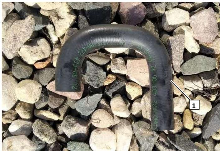
**1** разрезать шланг из головки блока на печку в 60мм от рамы (дистанция между отметками **2**)
