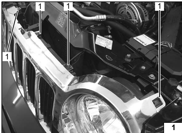
1 Clips der Kühlergrillbefestigung
