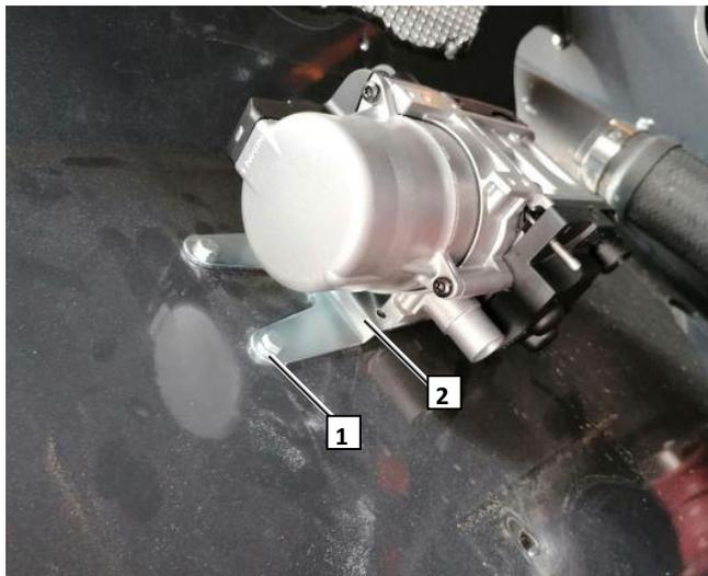
1 штатные отверстия крепления воздушного фильтра
