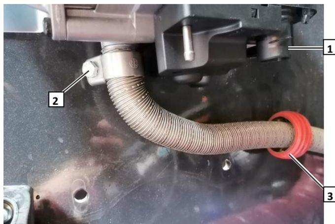
1 хомут крепления выхлопной трубы + болт М6 + гайка М6. Отверстие просверлить по месту
