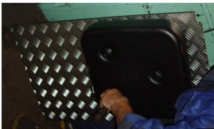
Топливный насос закрепить на смонтированном кронштейне рядом с отопителем. Перпендикулярно продольной оси авто, так чтобы штатного провода на насос-дозатор хватило для подключения.
