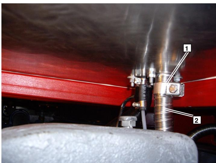
Направить выхлопную трубу в сторону противоположенную от патрубка забора воздуха (к левому борту автомобиля). В нижней точке перегиба сделать отверстие Ø3...4 мм для слива конденсата.
