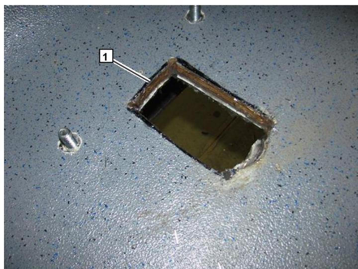
На фото изображен **пример** установки кронштейна воздушного отопителя. При данной установке отопитель сначала закрепляется на кронштейне, а затем кронштейн крепится к полу
