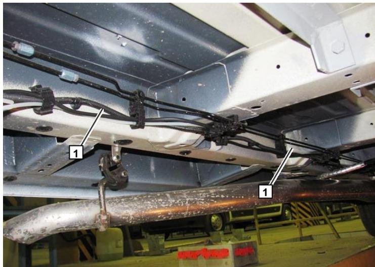
1 Топливный насос, штатная проушина, демпфер, гайка (2 шт)
