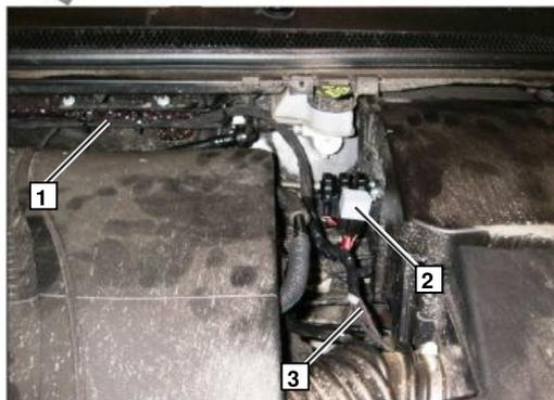
1. жгут на отопитель, орган управления, насос-дозатор, климат-контроль
