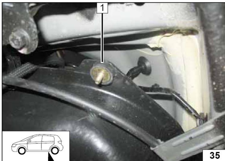
1 Разъем топливного насоса
